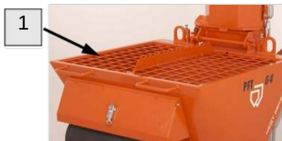
Fig. 30: Copertura a griglia
