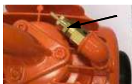
Fig. 103: Valvola di sicurezza
