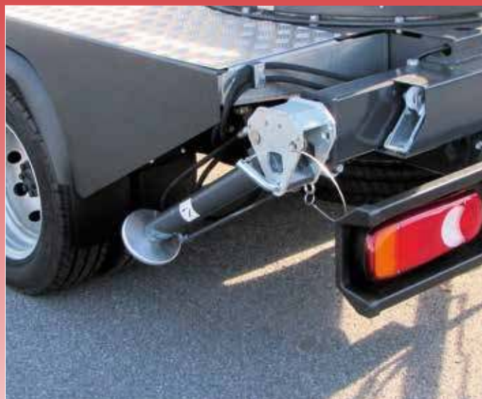
Stabilizzatori idraulici meccanicamente estraibili e orientabili a 60°
