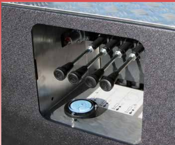
Postazione di comando degli stabilizzatori idraulici
