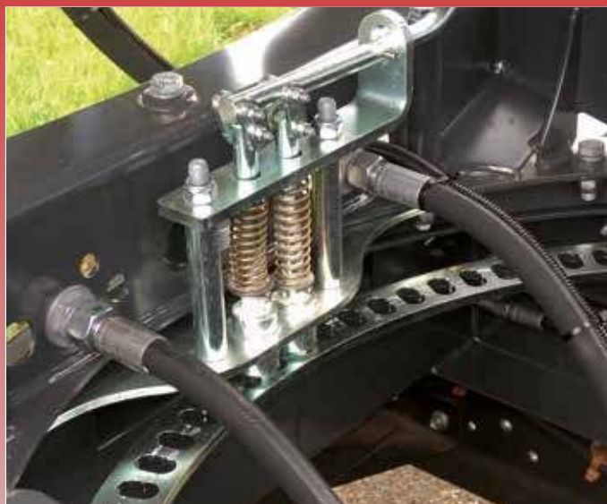
Ralla regolabile in continuo con bloccaggio a rilascio meccanico
